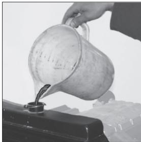
Con motori provvisti di serbatoio compensatore separato, introdurre il liquido fino al riferimento di livello massimo.
