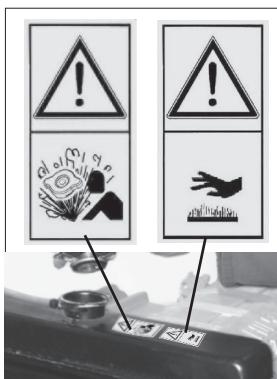
Il circuito di raffreddamento a liquido è in pressione, non effettuare controlli prima che il motore si sia raffreddato ed anche in quel caso aprire con cautela il tappo del radiatore o del vaso di espansione. Nel caso sia prevista una elettroventola non avvicinarsi a motore caldo perché potrebbe entrare in funzione anche a motore fermo. Il liquido di raffreddamento è inquinante, quindi deve essere smaltito nel rispetto dell'ambiente.
