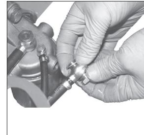
Posizionare la chiave avviamento sul primo scatto per alimentare l'elettrovalvola, o la pompa alimentazione elettrica.
