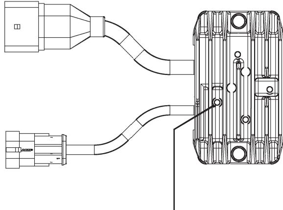
Il regolatore di tensione deve essere installato in una posizione ventilata lontana da fonti di calore.
