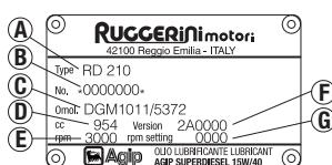
La placa de identificación del motor está colocada sobre la conducción del aire (fig.1, 22).
