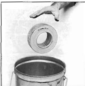
Sostituire con massa filtrante originale Lombardini.
